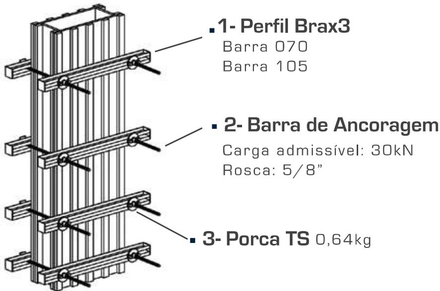
O sistema de Travamento de Pilar da Braxcon é composto de perfis Brax3, Barra de Ancoragem com porca TS.
